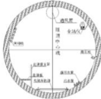
盾构隧道内管线布置示意图
